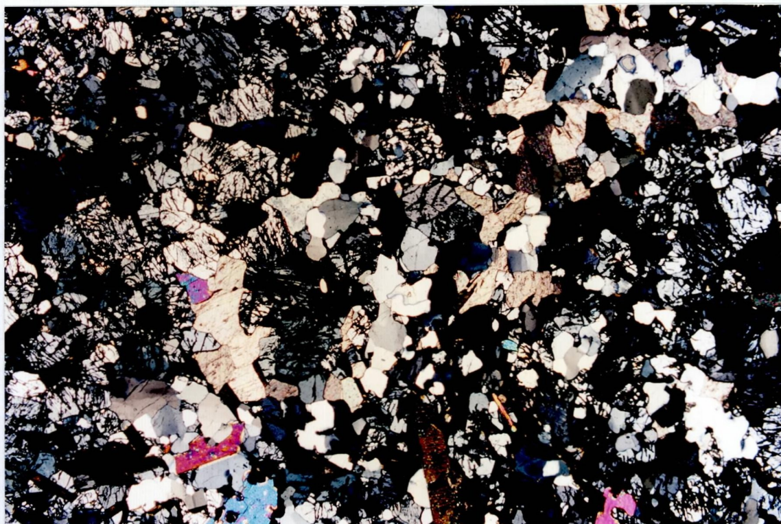
Figur 4: Karbonat-aggregater i mikroklingneiss (kremgul), ellers muskovitt, biotitt og kvarts i tillegg til feltspat (Prøve BG1798-60). Bildebredde 5.5 mm
