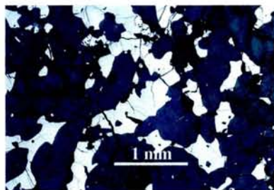
Figur 6.6: Mikrofotografier (reflektert lys) som viser typisk opptreden av ilmenitt (Ilm) og magnetitt (Mt) i polerte bergartsprøver (tynnslip) fra utvalgte lokaliteter. Venstre kolonne er oversiktsbilder (jfr. skalaen), mens høyre kolonne viser detaljer av oksydmineralene (ilmenitt og magnetitt). Silikatmineraler blir i disse bildene mørke grå til sort fordi de ikke reflekterer lyset i same grad som oksydmineralene. Små mengder sulfidmineraler, hovedsakelig magnetkis, forekommer i prøvene, men lar seg ikke i disse bildene skille fra magnetitt i særlig grad. Prøven fra Hauge gruve er av en relativt massiv ilmenitt-malm med store sammenvokste korn av ilmenitt og magnetitt. De øvrige eksemplene er fra disseminerte mineraliseringer i jotunitt (Rekefjord) og noritt (Åmdal, Teksevatnet og Mydland).
