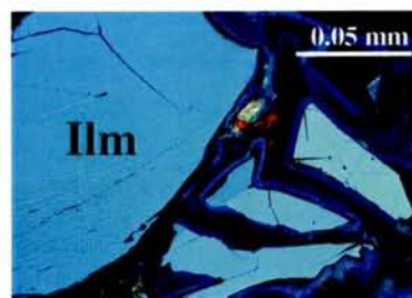
Figur 6.6: Mikrofotografier (reflektert lys) som viser typisk opptreden av ilmenitt (Ilm) og magnetitt (Mt) i polerte bergartsprøver (tynnslip) fra utvalgte lokaliteter. Venstre kolonne er oversiktsbilder (jfr. skalaen), mens høyre kolonne viser detaljer av oksydmineralene (ilmenitt og magnetitt). Silikatmineraler blir i disse bildene mørke grå til sort fordi de ikke reflekterer lyset i same grad som oksydmineralene. Små mengder sulfidmineraler, hovedsakelig magnetkis, forekommer i prøvene, men lar seg ikke i disse bildene skille fra magnetitt i særlig grad. Prøven fra Hauge gruve er av en relativt massiv ilmenitt-malm med store sammenvokste korn av ilmenitt og magnetitt. De øvrige eksemplene er fra disseminerte mineraliseringer i jotunitt (Rekefjord) og noritt (Åmdal, Teksevatnet og Mydland).
