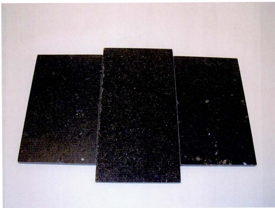
Figur 1. Polerte plater fra Finsethågen (15 x 25 cm). Fotografert mot Hasvik-gabbro (i midten) som referanse.
