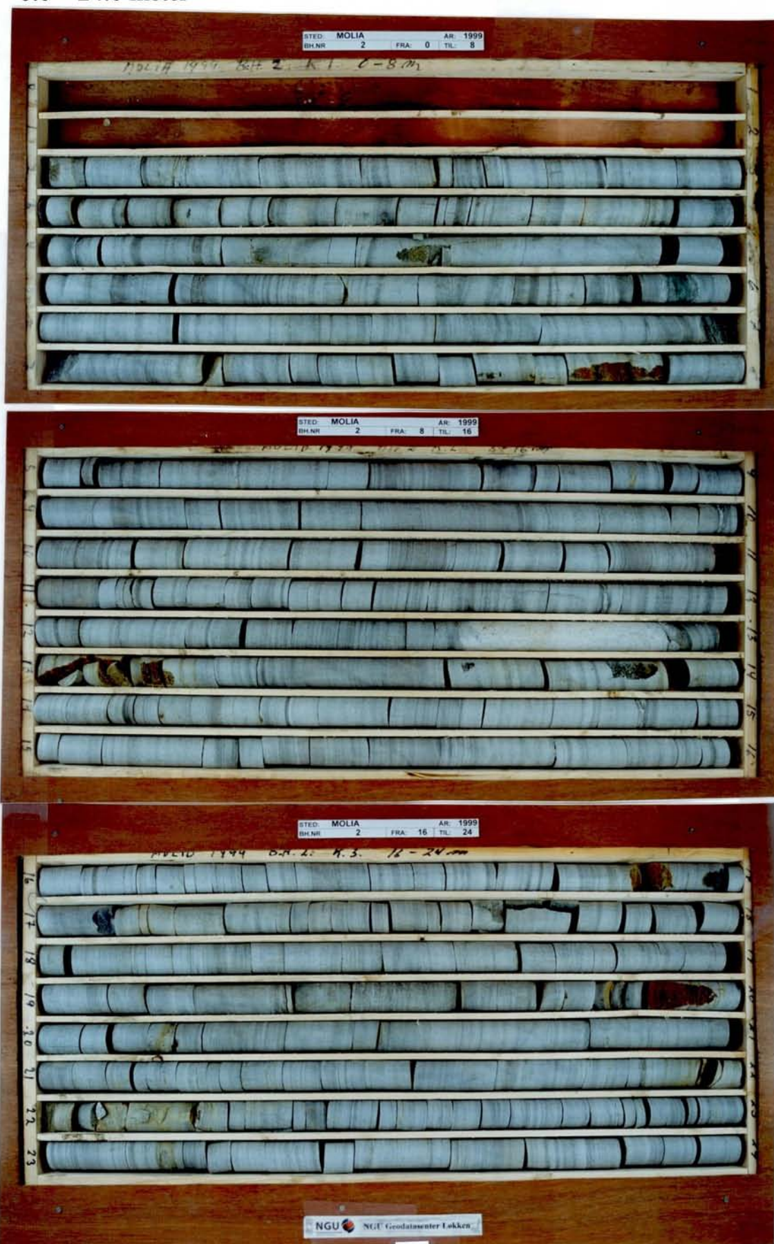
Figur 2: Fotograferte borkjerner fra Molid-skiferen, Bh 2. Fotograferingen er gjort på NGUs Geodatasenter på Løkken av Elin B. Sagvold. Se også borkjernebeskrivelse i Tabell 1. Foto av tørre kjerner. 0.0 – 24.0 meter
