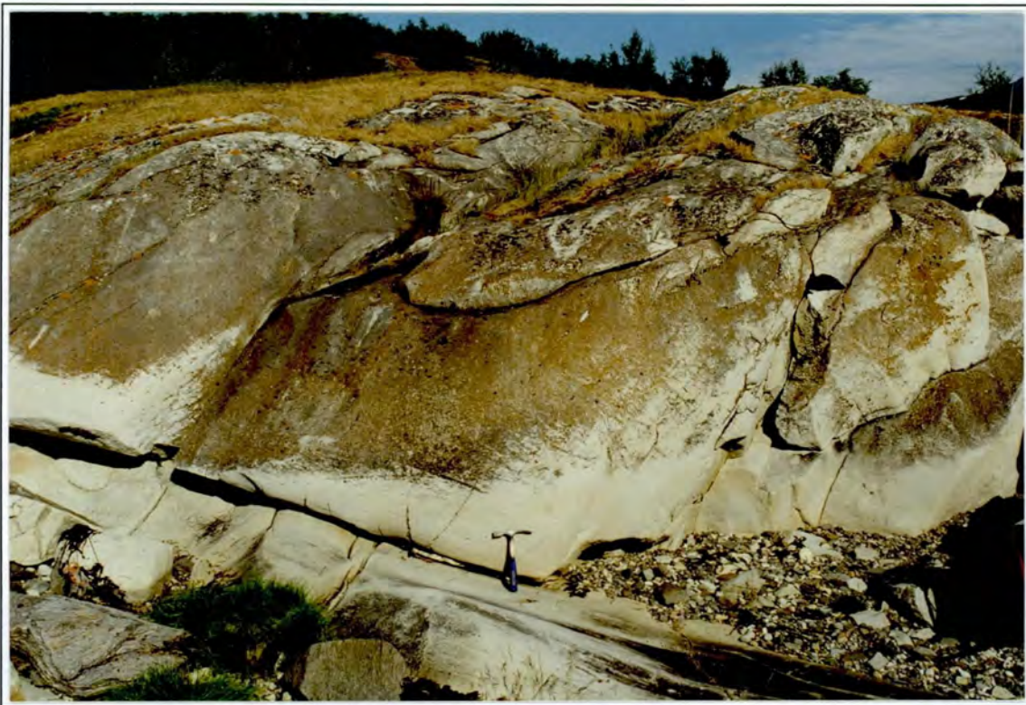
Figur 5. Reneste type dolomitt. Dette er en nesten hvit, massiv, overveiende grovkornet dolomitt med lite synlige forurensninger. Lokalitet: Ved Kveitneset, Rottenvik.
