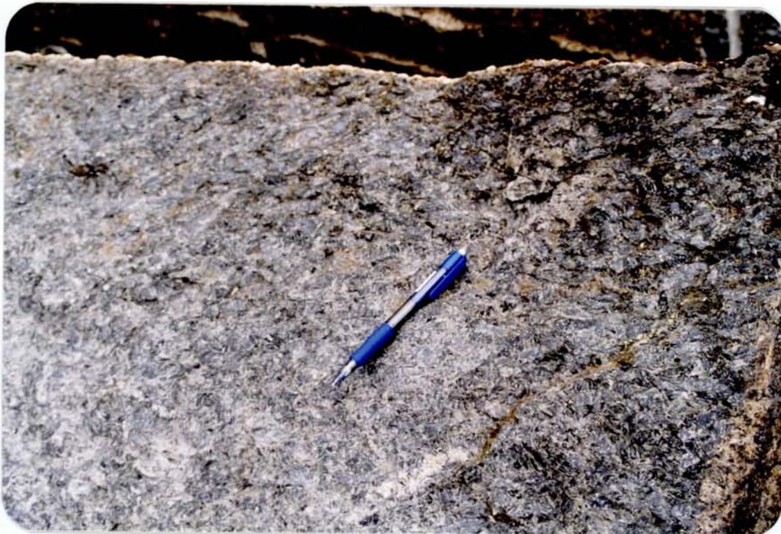
Figur 11 Detalj av forvitringssone der toppen av bildet tilsvarer fjellets dagoverflate. Merk brune sprekker og korngrenser som tiltar oppover i bildet.
