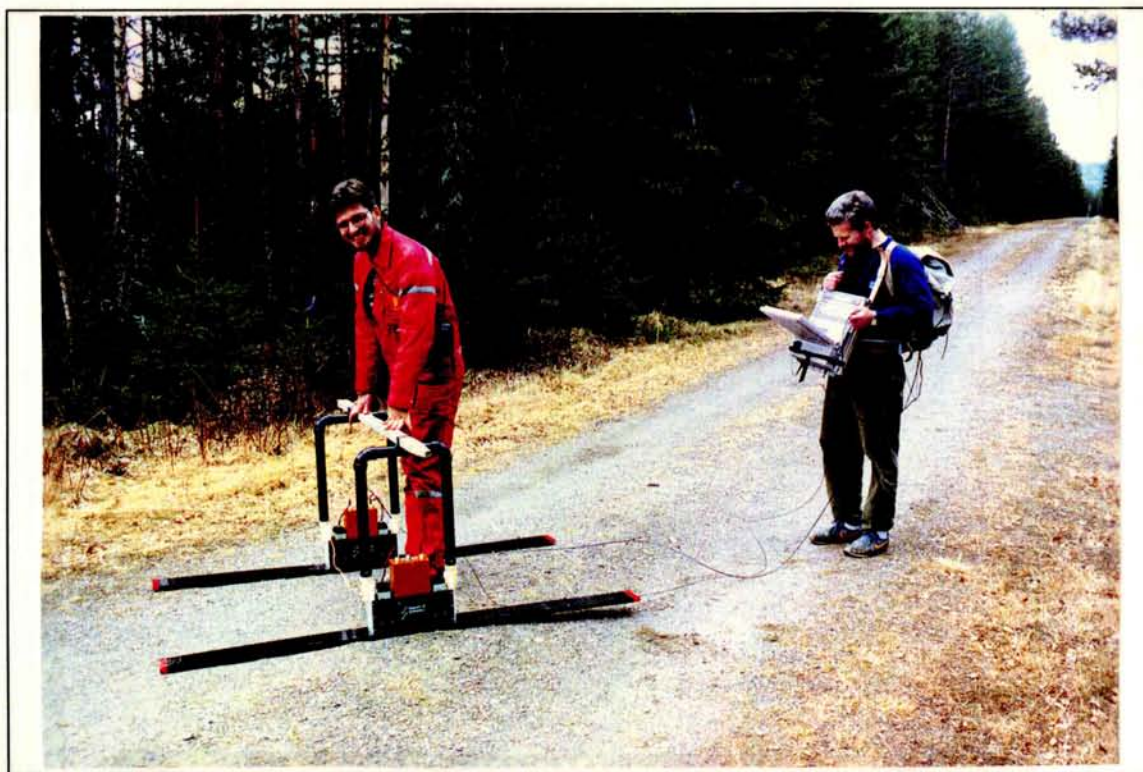
Figur 6.6. Bilde av pulseEKKO IV georadarsystem slik det opereres i felt.
