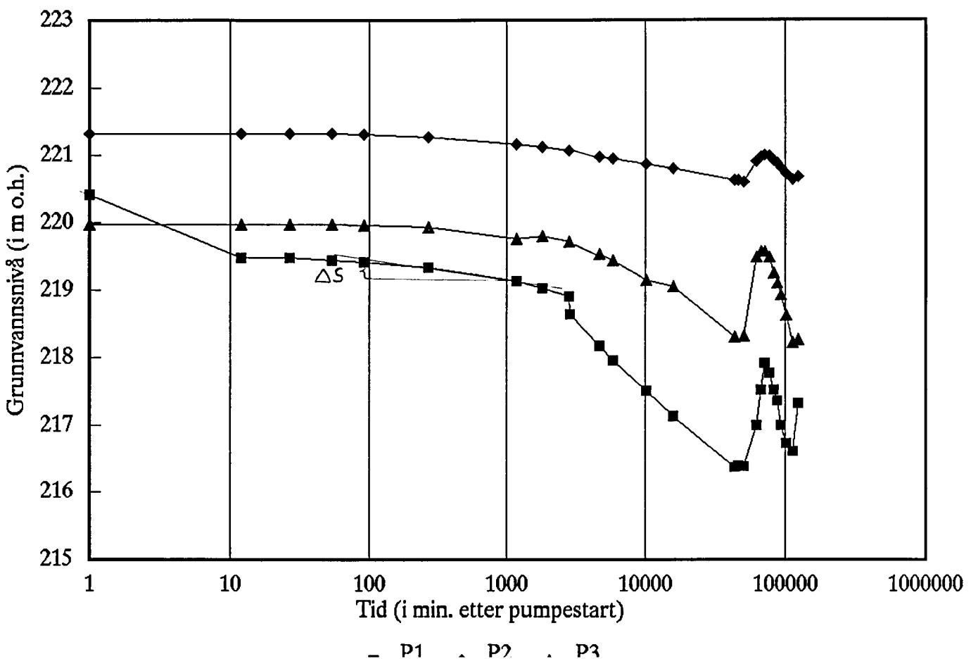
Fig. 1 Grunnvannsnivå i observasjonsbrønner under prøvepumping, Torsbustaden
