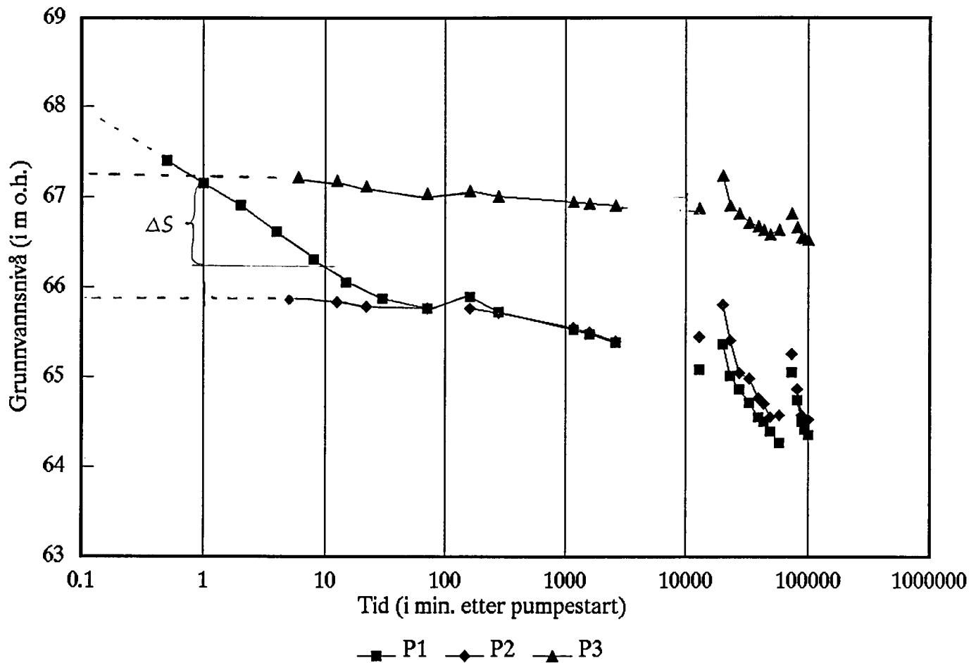
Fig. 2 Grunnvannsnivå i observasjonsbrønner under prøvepumping, Okkenhaug
