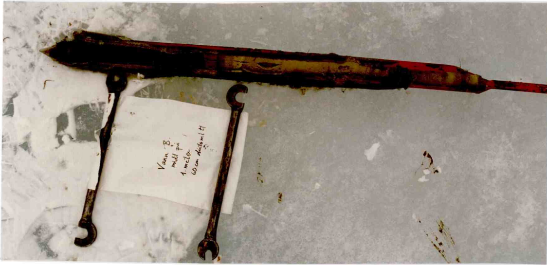
Figur 8. Bunnprøve fra midt ute i vann B. Her er diatomitten ikke ren.
