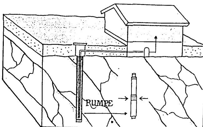
Det brukes pumper av forskjellige typer til å få ut vann av grunnvannsmagasinene. I borebrønn monteres dypbrønnpumpe, og pumpe med motor kan senkes ned i brønnen. Det kan også benyttes pumper som står oppe i dagen, men da må noe vann føres ned igjen i brønnen. Returvannet trekker nytt vann ned gjennom en "ejektor".
