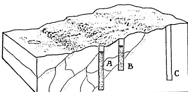
Ved boring etter vann brukes i dag kompressordrevne boremaskiner. En spesiell borekrone arbeider seg gjennom fjell ved rotasjon og slag. For å finne vann må boret treffe enn vannførende sprekk.
