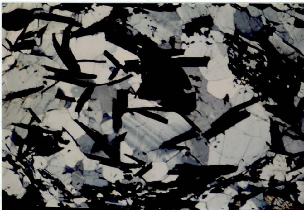
Figur 46 Tynnslip bilde av grafitt malm prøve 9121c
