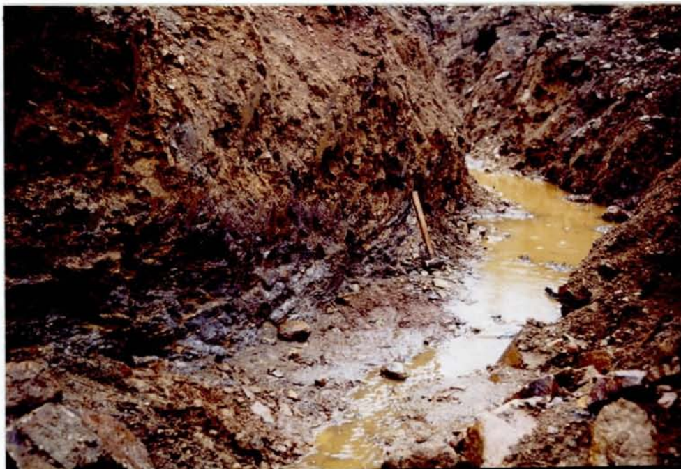
Figur 12 Bilde fra røsk 8, 1991 viser hvordan grafittskiferen ligger i hele grøftas bredde
