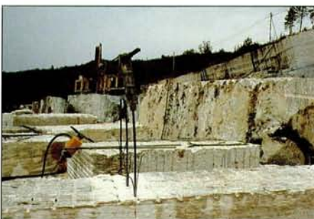
Moderne metoder tas i bruk for skånsom brytning av naturstein. I Fauske brytes marmor ved hjelp av linesaging.
