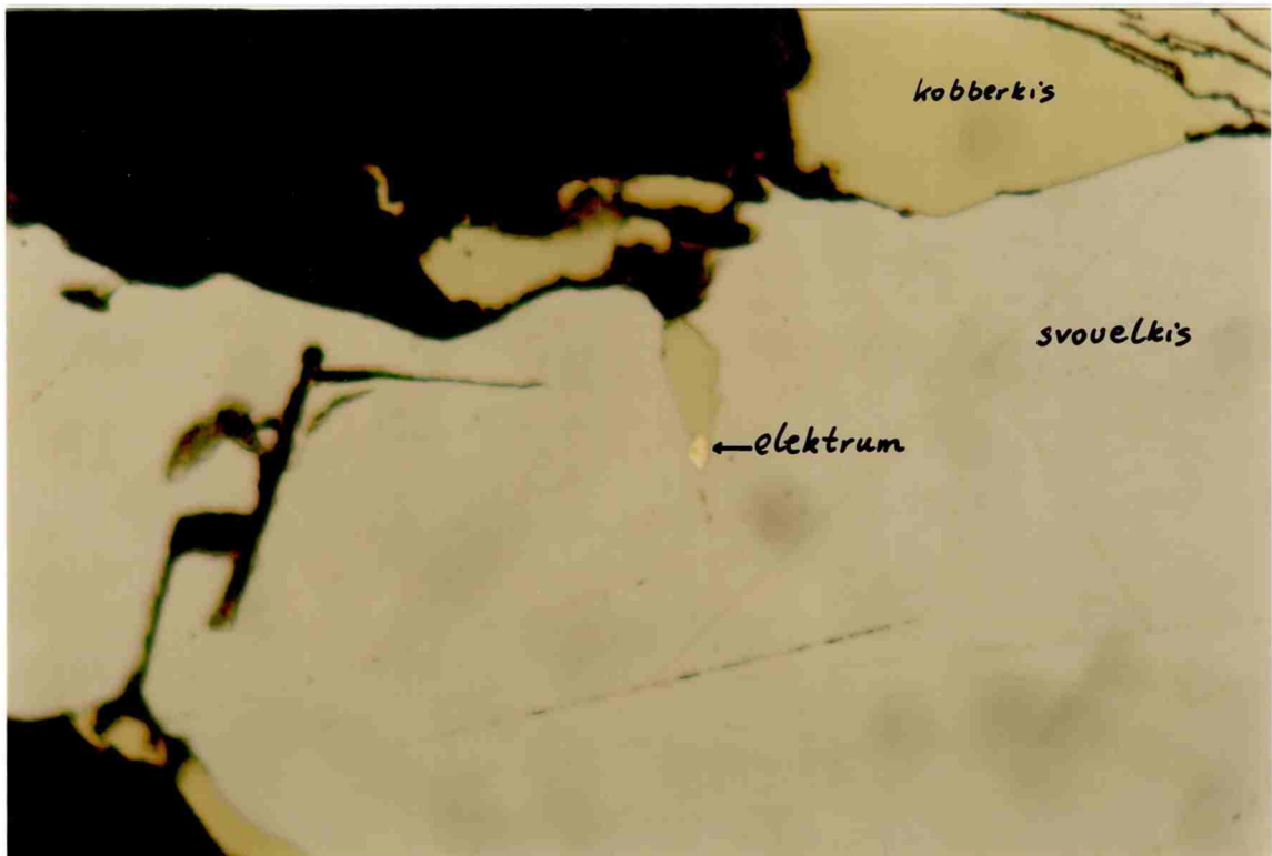
FIGUR 19: Elektrum-korn i kobberkis som trenger inn i svovelkis i Skaudalen (slip 9708). Billedbredde 0.23 mm.
