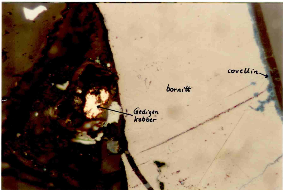
FIGUR 20: Uregelmessig korn av gedigen kobber nær bornitt i Skaudalen (slip 21995). Billedbredde 0.23 mm.
