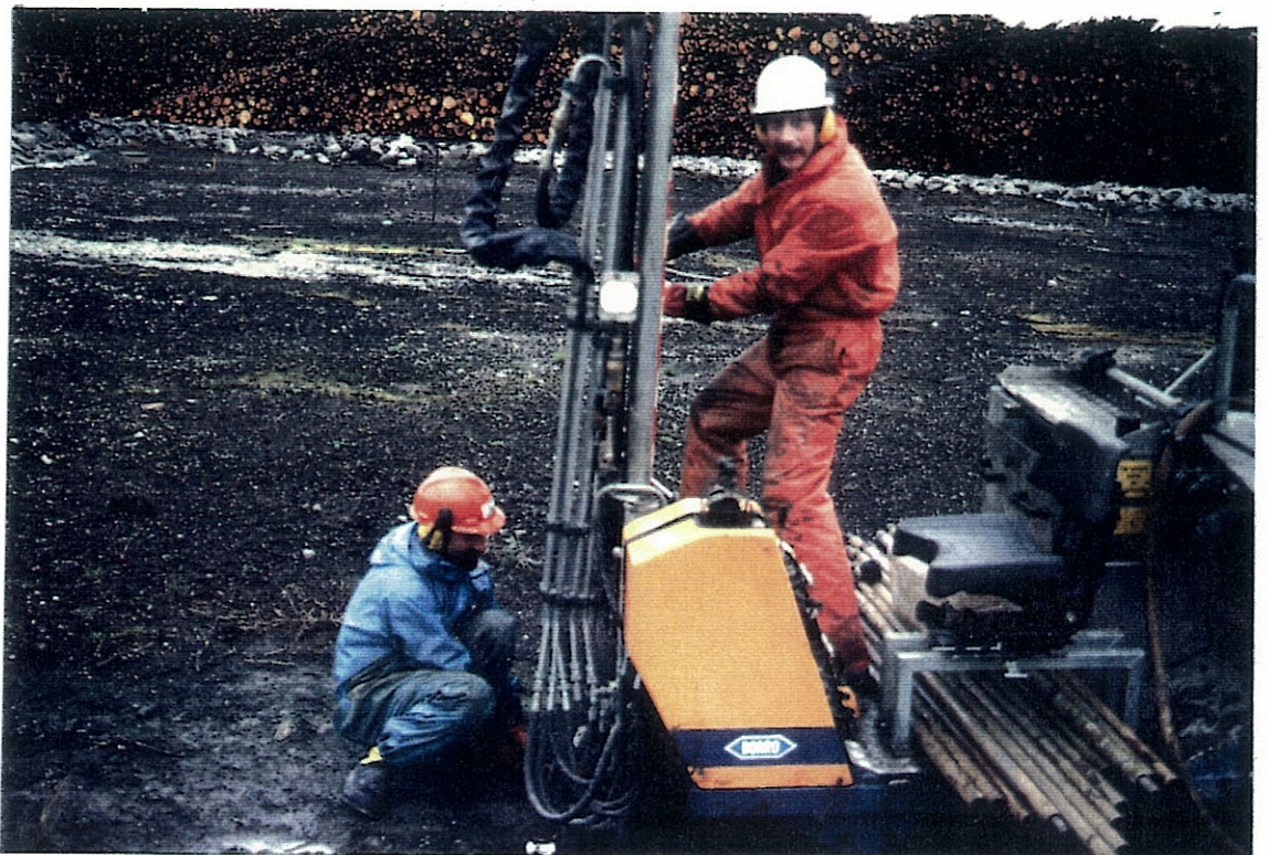
Figur 2. Prøvetaking av industriavfall og naturlige sedimenter på Opsund deponi ble bl.a. foretatt med en Borros-rigg med ramprøvetaker.
