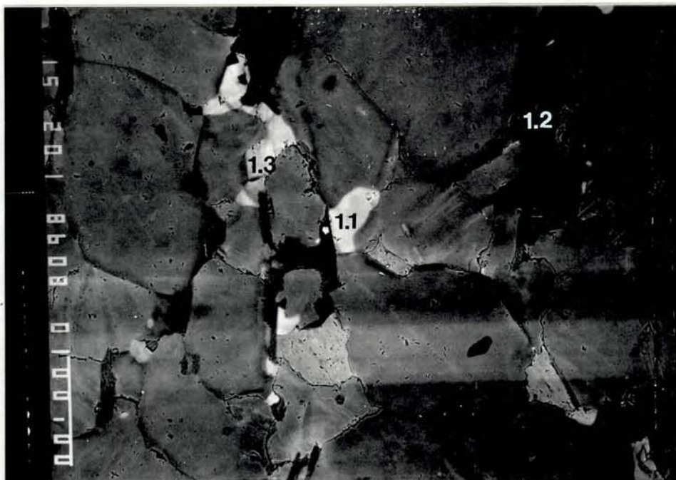
1009. Område 1. Røntgenrefleksjon og katodeluminiscens 200 x. Mesteparten av feltet er kvarts. Tallene refererer til feltspatanalyser. 1.1. kalifeltspat, 1.2. albitt, 1.3. oligoklas.
