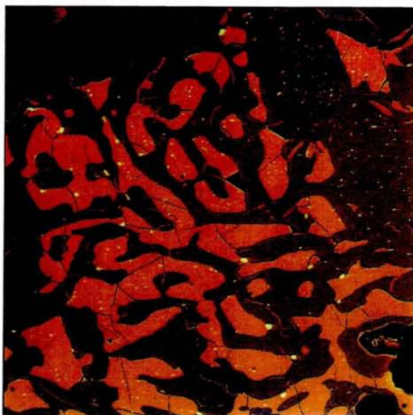
Fig. 3.a. Små inneslutninger av neumannitt i kobberglans og bornitt. Ca. 200X forstørrelse. Fargene er falske men relativt refleksjons er noenlunde korrekt.
