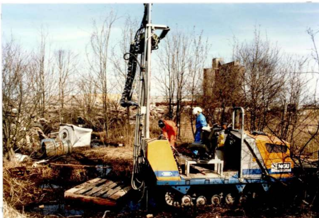
Figur 5. Prøvetaking av industriavfall og naturlige sedimenter på Opsund deponi ble bl.a. foretatt med en Borros-rigg med rammeprøvetaker.
