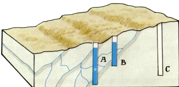
Ved boring etter vann brukes i dag kompressordrevne boremaskiner. En spesiell borekrone arbeider seg gjennom fjell ved rotasjon og slag. For å finne vann må boret treffe enn vannførende sprekksone.
