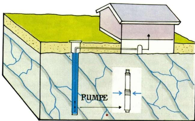
Det brukes pumper av forskjellige typer til å få ut vann av grunnvannsmagasinene. I borebrønn monteres dypbrønnpumpe, og pumpe med motor kan senkes ned i brønnen. Det kan også benyttes pumper som står oppe i dagen, men da må noe vann føres ned igjen i brønnen. Returvannet trekker nytt vann ned gjennom en "ejektor".
