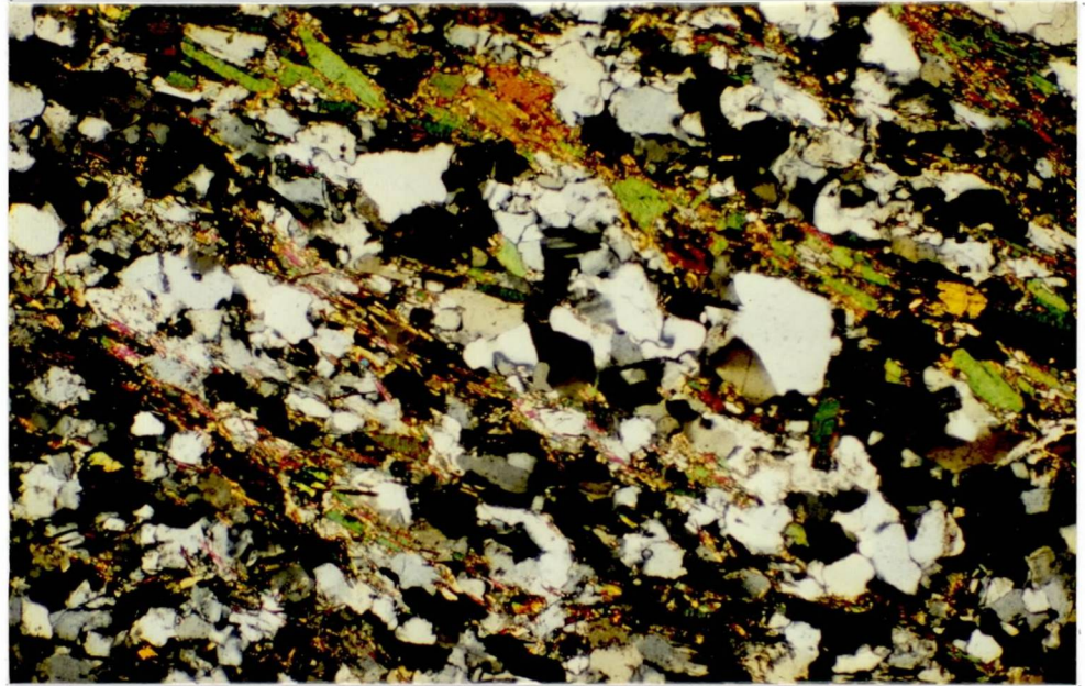
Fig. 4. Balgesvarrigneisen, lok. 389 950. Granulær kvarts-plagioklas-K-feltspat-gneis. Muskovitt og epidot langs tynne skjærplan. Forstørret 100 x, X-nicols.
