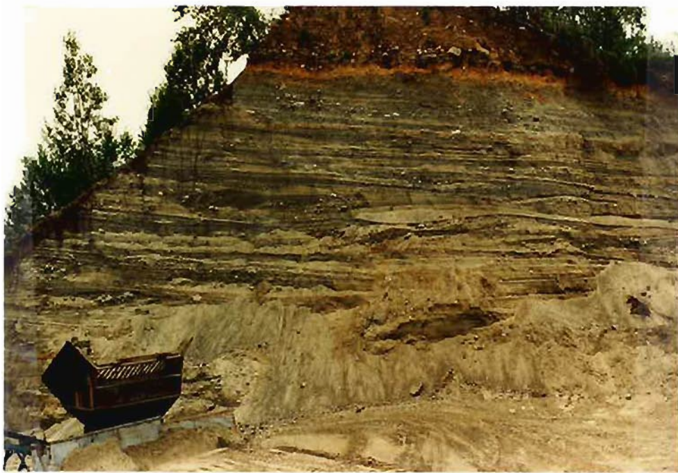
Fig. 3: Lagdelt grusig sand i veksling med rene sandlag og siltig sand. Snittbeskrivelse 2. Delområde 2.
