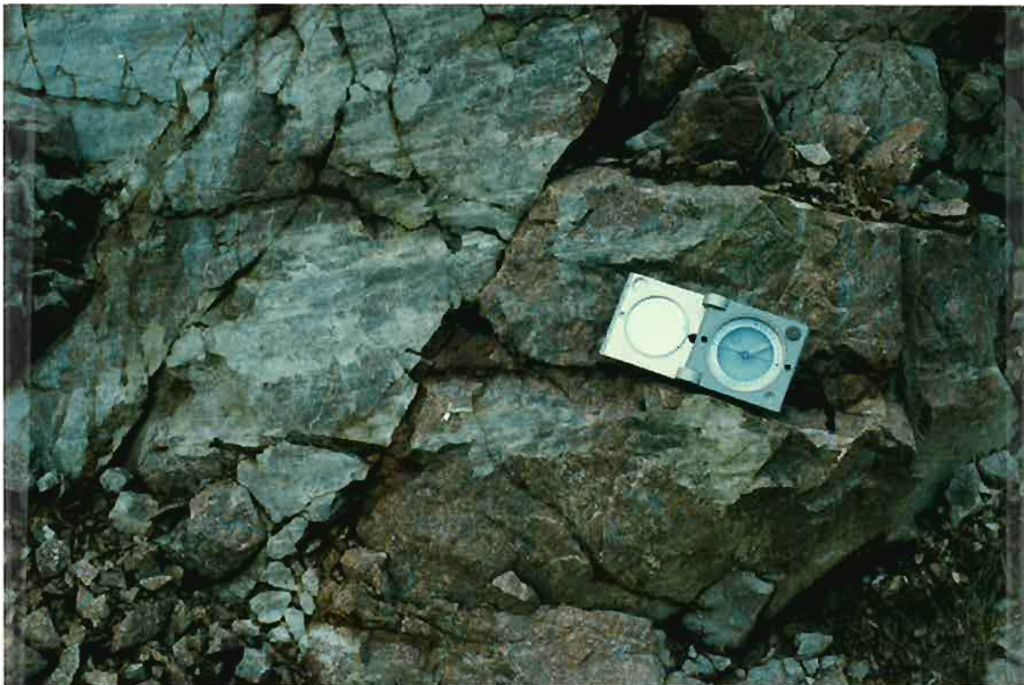
Fig. 25: Nærbilde av knusningssonen i Fig. 24 viser glidespeil med glide- striper og rød omvandling.
