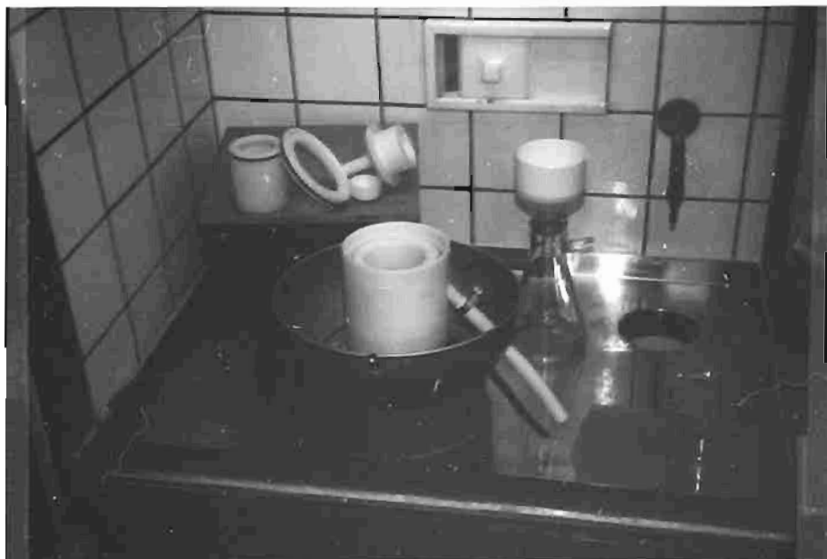
Foto nr. 7. Tungvæske-sentrifugalseparator. Bildet viser delene separatore er sammensatt av. Innmaten er montert i en vanlig bordmodell av en laboratoriesentrifuge.
