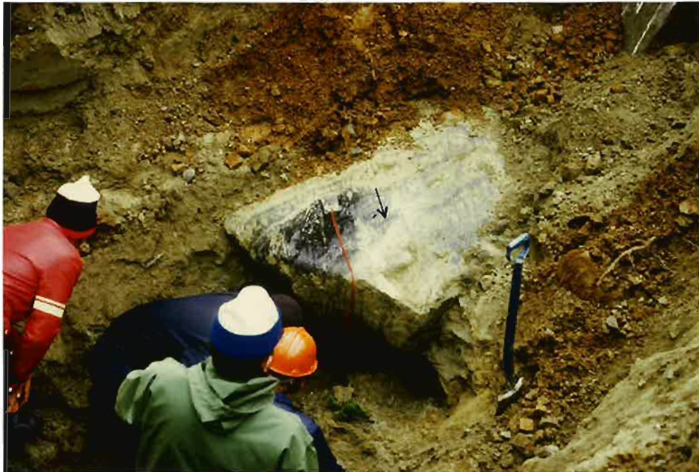
Fig.9: Isskurt moreneblokk i toppen av undre morene. Skuringsretning mot 30-35^{\circ} . Hovedmaksimum for fabric i morenen stratigrafisk omlag 20-30 cm over (og ca. 1 m til side for) blokka ligger på 30-40^{\circ} . Det vil si at fabric og skuring passer meget godt overens.
