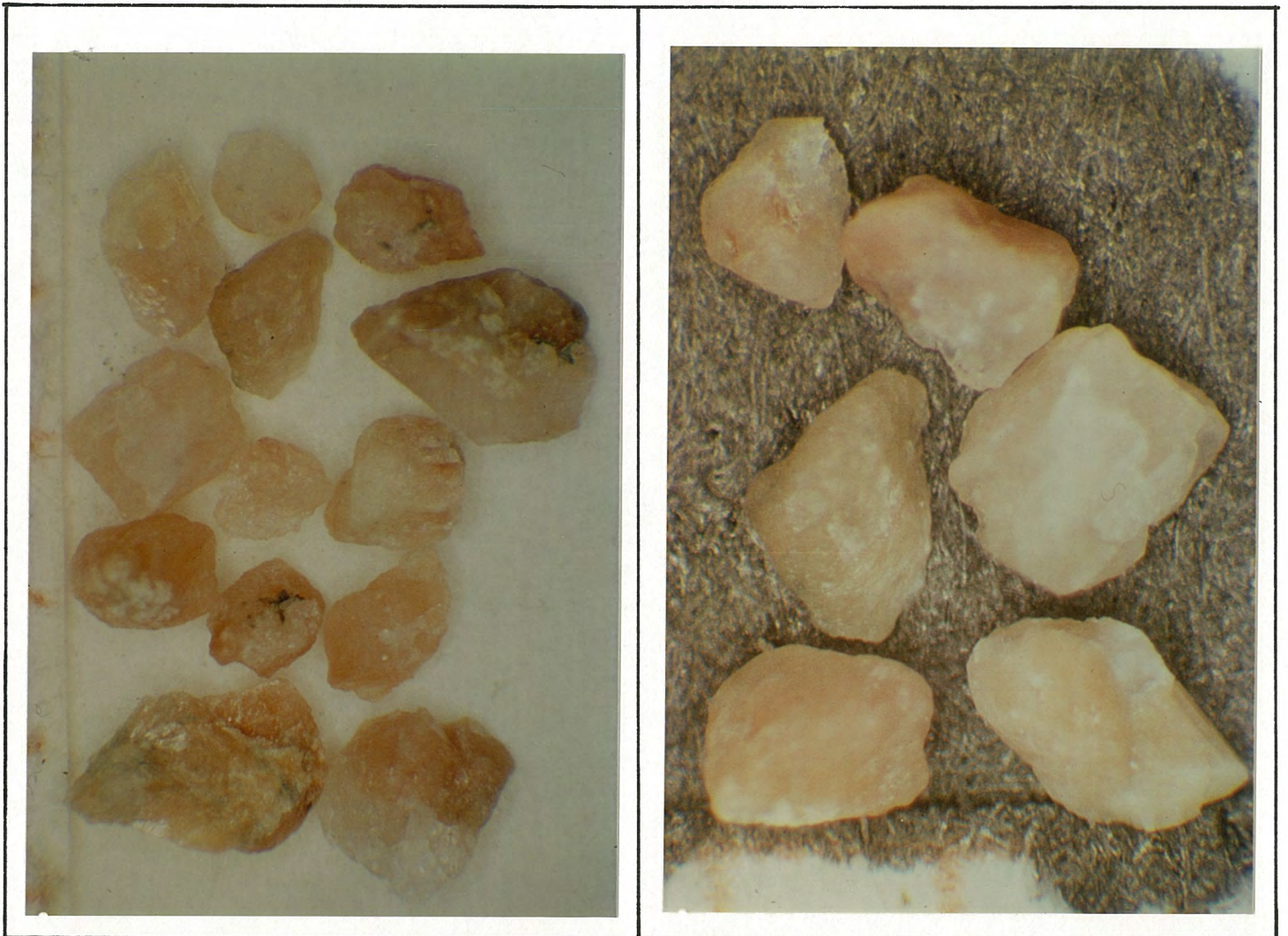
I. Feltspat med karakteristisk blekrød/rosa farge (alkalifeltspat)
