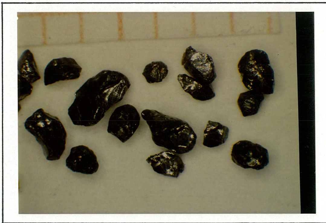
I. Magnetittkorn med metallglans og typisk buede, glassaktige bruddflater.
