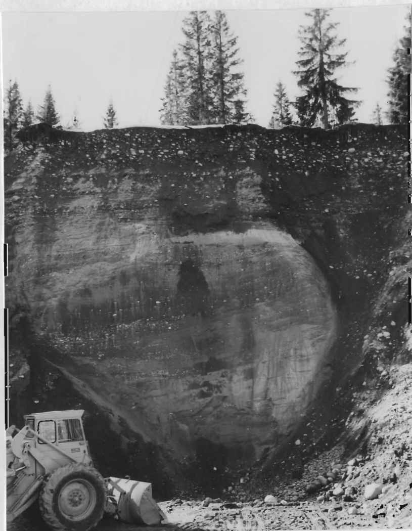
Vedlegg 12, bilde 3. Vilberg grustak, syd for jernbanelinjen. Bildet er fra SV-veggen i grustaket. Fotografert høsten 1975. Målestokk ca. 1 : 180. Profilbeskrivelse fra grustaket, se p 13.
