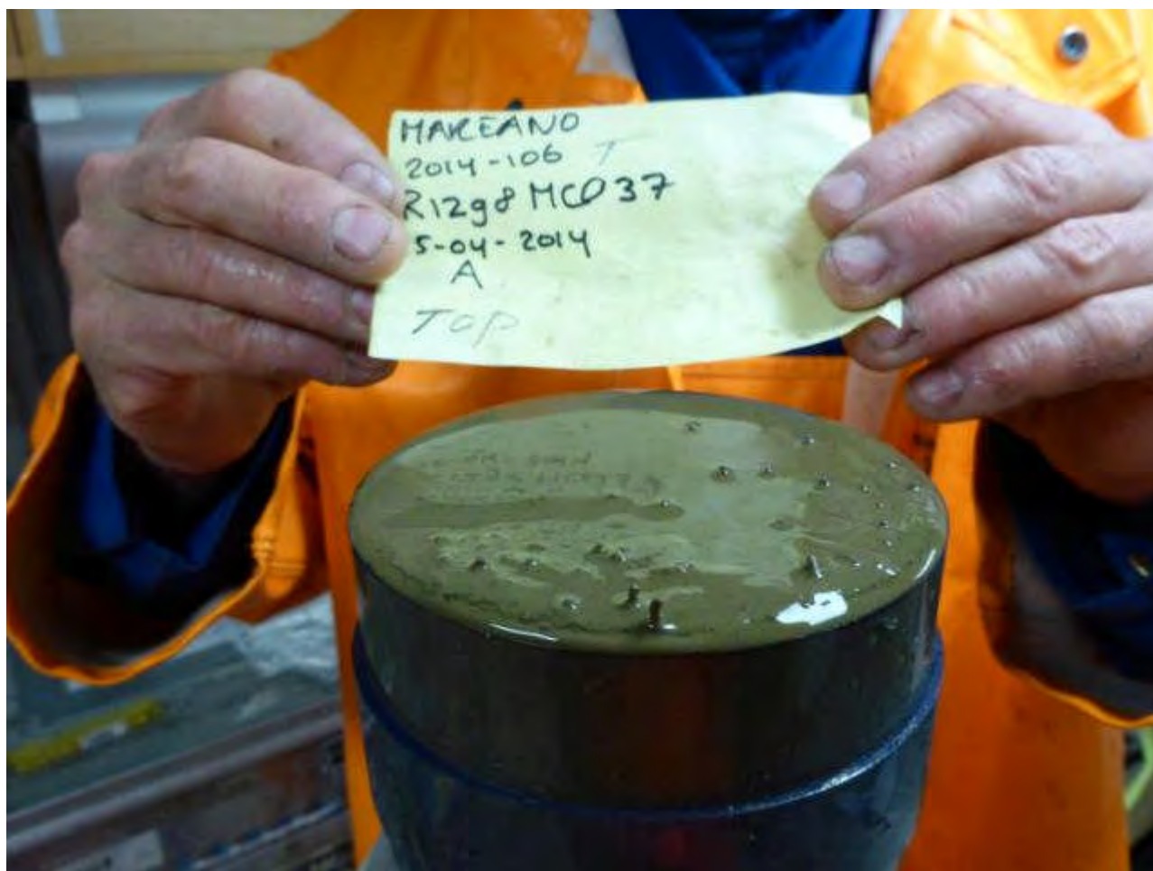
Figur 3. Toppen av sedimentkjerne "A" fra stasjon R1298MC037, før sedimentkjernen deles opp i 1-cm tykke skiver. De øverste centimeter har høyt vanninnhold.
