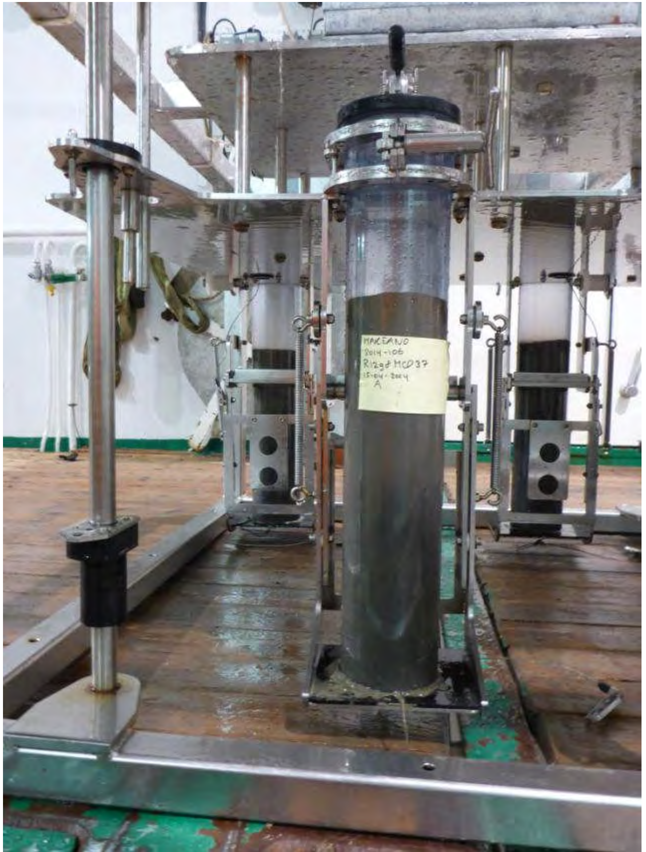
Figur 2. Multicorer med sedimentkjerne fra stasjon R1298 utenfor Finnmark. Denne sedimentkjernen er 42 cm lang, og det ble tatt prøver til kjemiske analyser og dateringsanalyser gjennom hele sedimentkjernen.
