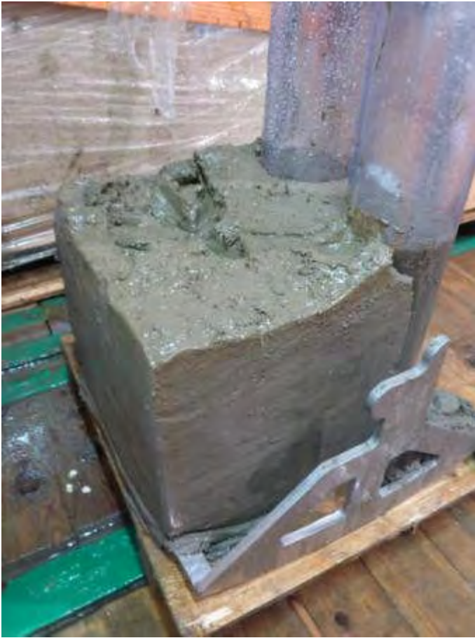
Figur 4. To rør i boxcorer for uttak av sedimentkjerner fra stasjon R1320 utenfor Finnmark.
