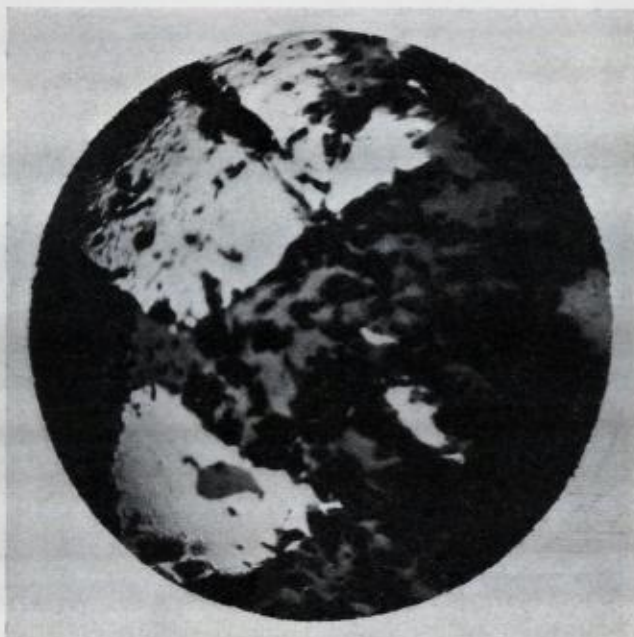
Fig. 56. Killingdal grube. Meget sinkrik kis fra Nordgruben, ca. 200×forst.
