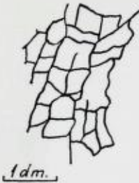
Fig. 62. Solvarme sprekker i amfibolitt.
