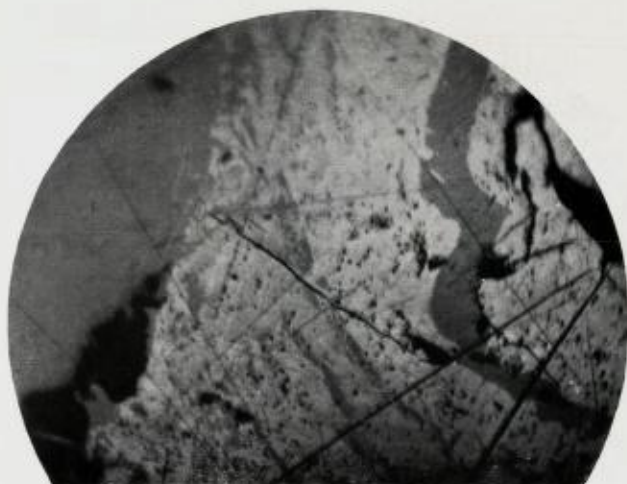
Fig. 1. Bornitt (mørk grå) og kobberglans (gråhvit) med fortrenningsrester av bornitt. Bugtedalen skjerp. Polerslip. Oljeimmersjon \times 225 . St. Foslie fot.
