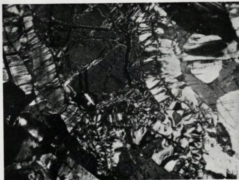
Fig. 5. Olivinnoritt. \times nic. forst. 55 ganger. I centrum olivin omgitt av corona som innerst består av enstatit og ytterst av pyroksen-spinell symplektit.
