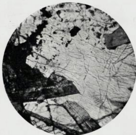
Fig. 6. Dolerit, „Schetelig's gang“, høide 992. Frisk titanaugit som omslutter plagioklas og litt erts. Pyroxenen er skåret omtrent loddrett på c-aksen. + nik. 19 ×.
