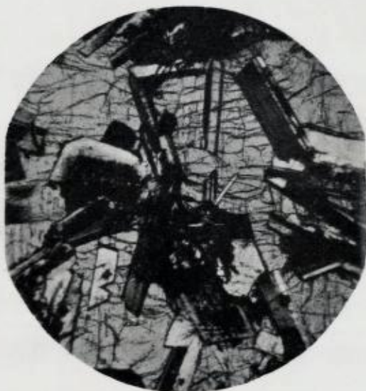
Fig. 5. Dolerit, Brurhøgda. Oftisk tekstur. Stor titanaugit som omslutter plagioklaslister. Til venstre oprinnelig zonarbygget plagioklas hvor kjernen nu er saussuritiseret. + nik. 36 ×.
