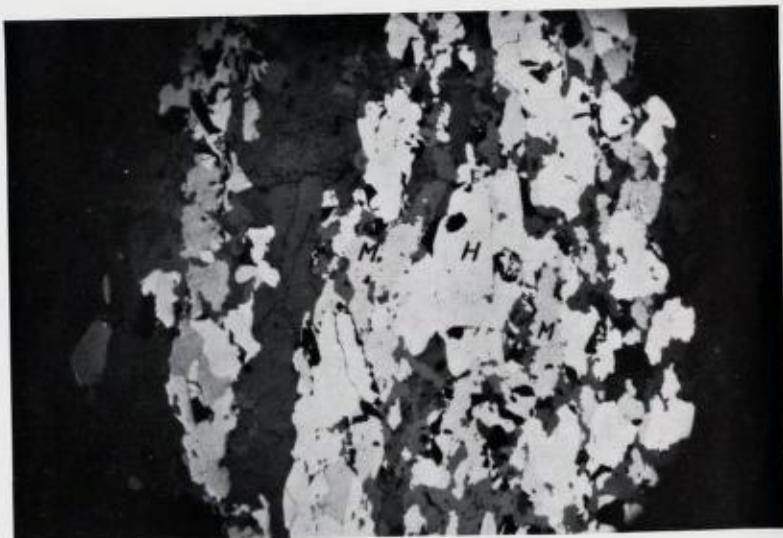
Fig. 2. Smalt bånd i spessartin-skarn av jernglans (hvit, H) og magnetitt
