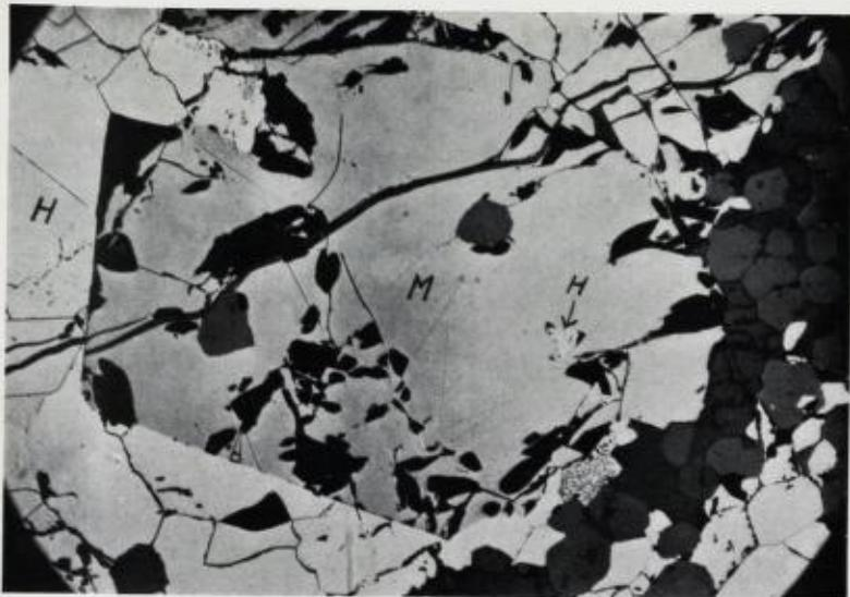
Fig. 1. Stor magnetittporfyroblast (M) med vakker krystallbegrensning mot kornig jernglans (H). Inneslutning av jernglans. Polerslip, 45 ×.
