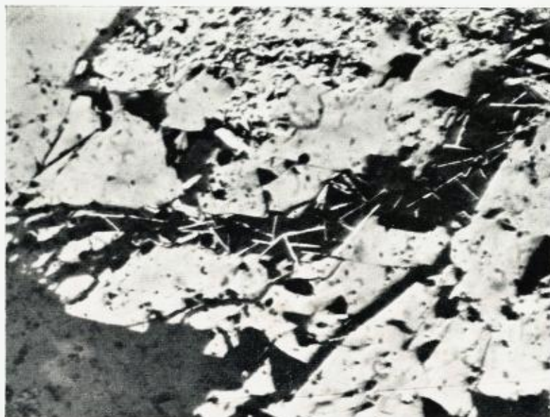
Fig. 5. Polerslip. Hvite jernglansnåler i kvarts. Grått min. er magnetkis. Hvitt min. er arsenkis. 80× forst.
