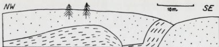
Fig. 20. Profil av grensen mellom alunskifer og Kvartssandsten av det øvre skyvedekke ved Olslykkja (56, 65).
