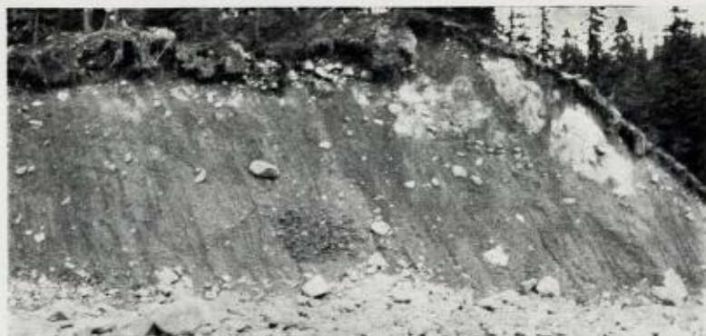
Fig. 31. Skjæring i forholdsvis stenfattig bregrus på nordsiden av Reinsjøbekken like ovenfor dens utløp i Muggedøla (41.3, 8.8).
