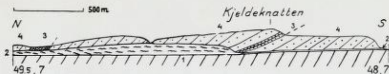
Fig. 24. Skjellstruktur i Kwartssandstenen, profil over Kjeldeknatten. 1. Grunnfjell. 2. Kambrisk alunskifer. 3. Finkornet sandsten i den undre del av Kwartssandstenen. 4. Alminnelig grovkornet Kwartssandsten.
