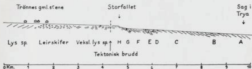
Fig. 30. Profil langs Trya. Lagserien A—H (se fig. 31) tilhører Kvitvola-dekket, lagene ovenfor det tektoniske brudd sannsynligvis den parautochtone serie.
