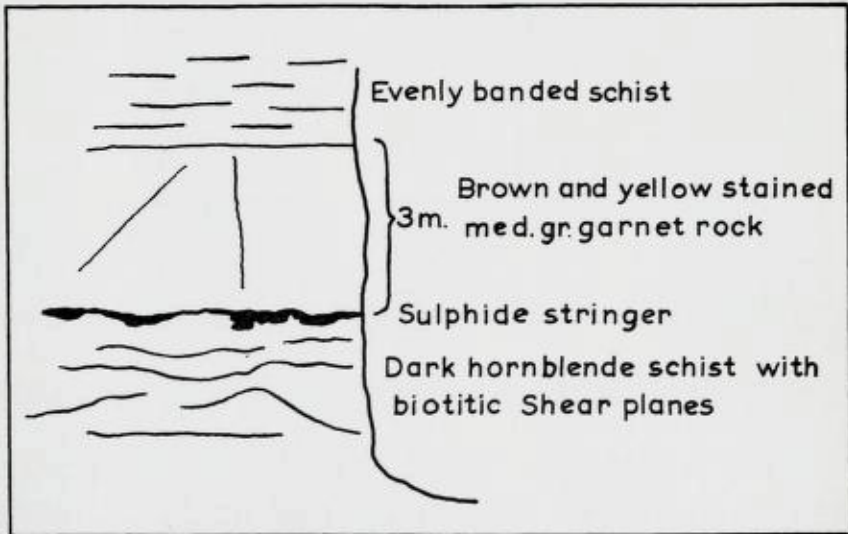
Fig. 67. Vertical section through the outcrop at Brattfjell mine, Skardalen. Vertikalt snitt gjennom malmsonen ved Brattfjell gruve, Skardalen.
