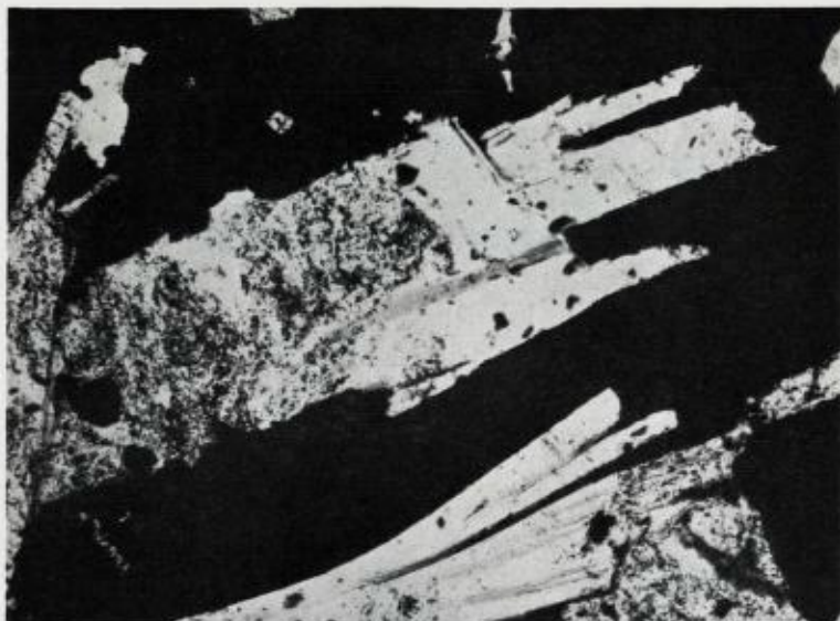
Fig. 6. Utsnitt av fig. 3: Muskovittflak, svakt korrodert og bøyet av kopperkis. Gjennomfallende lys. 90 \times .
