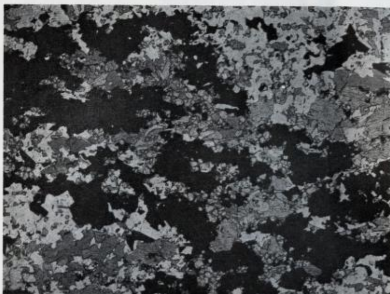
Fig. 7. Grube Rødsand, +4 m-Sohle. Dünnschliff, Übersichtsbild vom H-Erz. Vergr. 12\times . Erz schwarz, Feldspat weiss, Hornblende grau, Granat etwas heller grau (runde Körner). Phot. A. Iversen.
