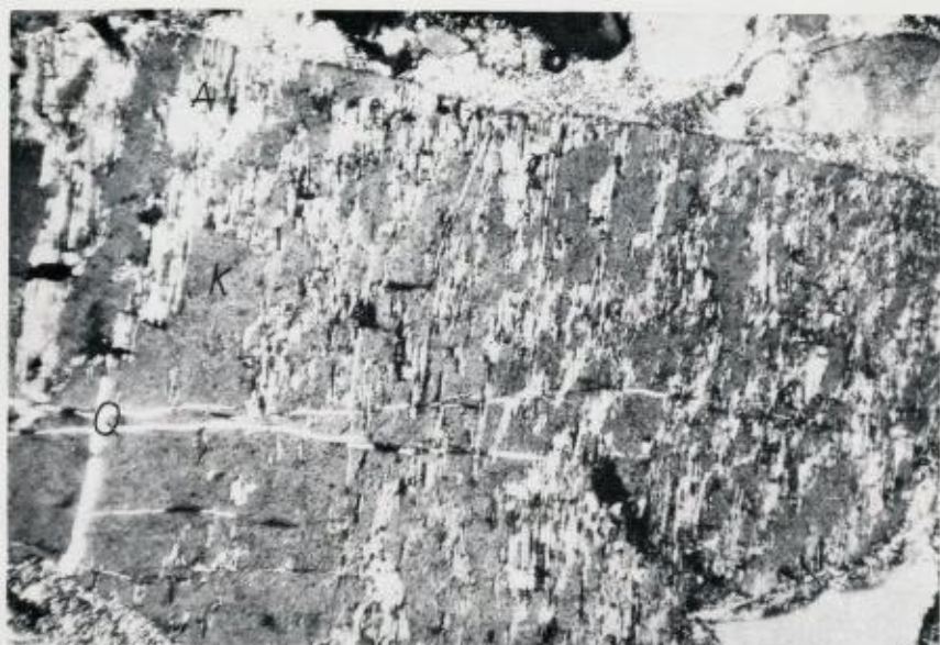
Abb. 3. Flecken-Perthit mit verzwilligten Flecken aus dem Valdres-Sparagmit (Typ Rognslifjell), nördlich Rundemellen. K Kalifeldspar, A nach dem Albit-Gesetz verzwilligter Albit, Q Sprünge, die mit Quarz verheilt sind. Gekreuzte Nicols. Vergrößerung: 40 fach.
