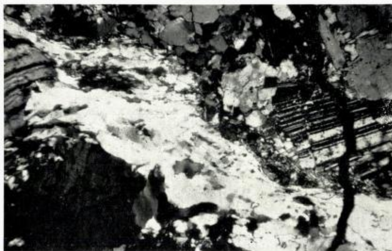
Foto 3. Mylonittgneistekstur. Rekrystallisert, sterkt uttrukket og suturert kvarts og delvis oppbrudt feltspat. Fra granitt i Kongsvinger. x31. Mylonite gneiss texture. Recrystallized, deformed and sutured quartz and partly fractured feldspar. From granite in Kongsvinger. x31.
