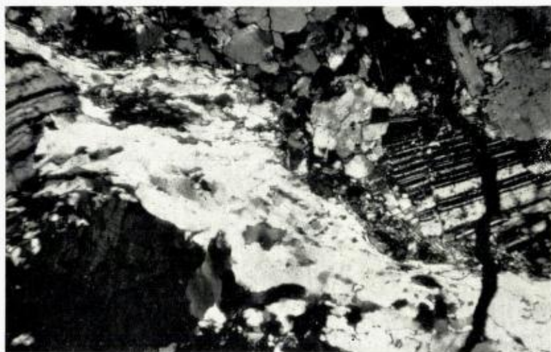
Foto 3. Mylonittgneistekstur. Rekrystallisert, sterkt uttrukket og suturert kvarts og delvis oppbruddt feltspat. Fra granitt i Kongsvinger. x31. Mylonite gneiss texture. Recrystallized, deformed and sutured quartz and partly fractured feldspar. From granite in Kongsvinger. x31.
