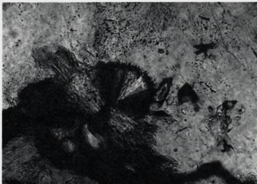
Fig. 10. Vein quartz with spherulitic chlorite inclusions. + Nic. · 190. Gangkvarts med sfæriske klorittinneslutninger. + Nic. · 190.
