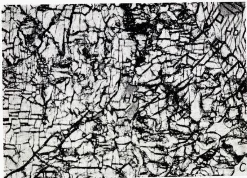
Figur 8. Diopsidblast mit kleinen Einschlüssen von grüner Hornblende neben Calcit und Hornblende Vergrößerung 200-fach, Probe 575 N-Talgje.
