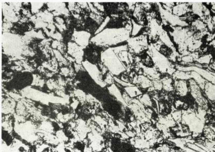
Fig. 8. Rød sandstein med hematitt som er dannet ved oksydisk vitring av silikater. Kornet i sentrum er en nesten helt omvandlet kloritt. Heilefjelllets austlige del. Heilefjellformasjonen. (Planpolarisert lys, ca. 150 x).
