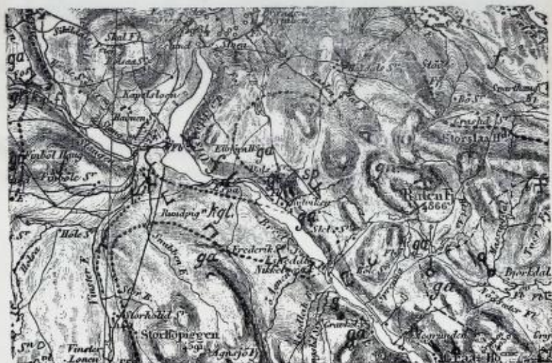
Kart over trakten omkring Slangen, Olstappen og Bredsjøen. \frac{1}{200\ 000} . f., fyllit; sp., yngre sparagmit; kgl., konglomerat; ga., gabbro; gr., granit; gn., gneis; s., serpentin med klæbersten.
