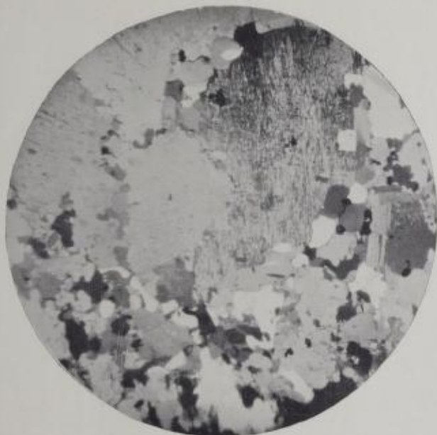
Fig. 1. Granit ved Tjørisev. Feltspaten i stor utstrækning mikropertitisk sammenvokset. + Nikoller, 24 \times .
