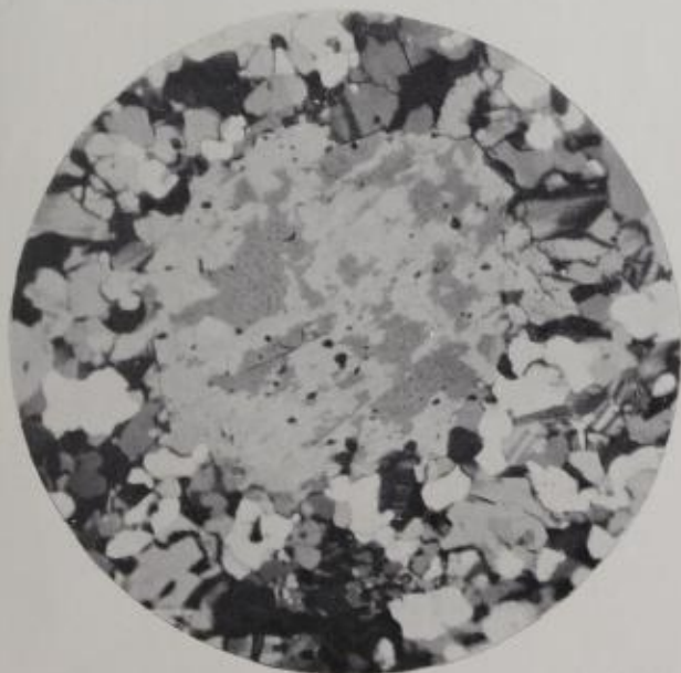
Fig. 2. Forskifret granit fra Skaitiaksla. Mikropertitisk feltspat. + Nikoller, 40 \times .
