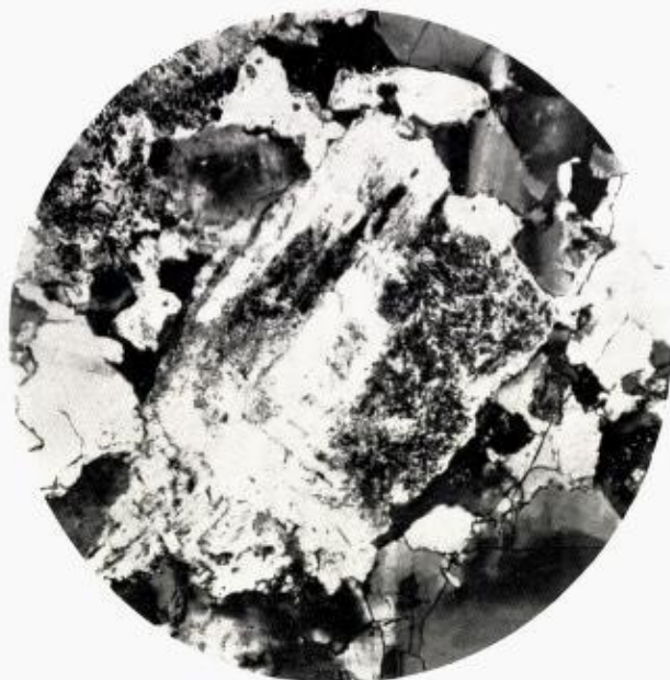
Fig. 1. Mikroskopisk præparat av hvit granit.
