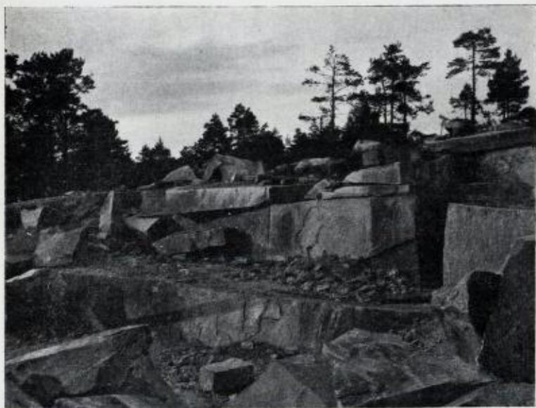
Brudd øst for Id. Fjeldoverflaten holder vestover, mens bænkingen holder østover.
