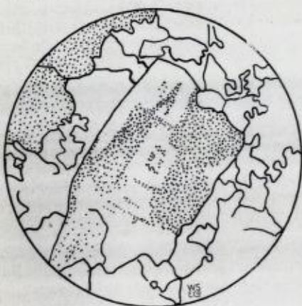
Mikroskopisk præparat av en granit fra Sogn. Det store individ i midten og øverst tilvenstre er feldspat, tildels omvandlet (de prikkede partier). Det øvrige er kvarts. Feldspaten viser sonar opbygning. Bergarten har symplex struktur.
