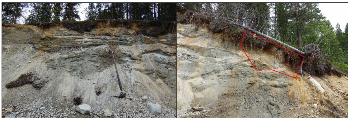
Figur 5: Bilder fra massetak 1 i Lindalen grusforekomst. Massene består av silt- og sandrike lag med sand- og grus-rike mellomag (venstre bilde). Kun i den sørlige delen av massetaket finnes litt mektigere sand- og gruslag (rød markert i høyre bilde), hvor massene tidligere har blitt tatt ut.
