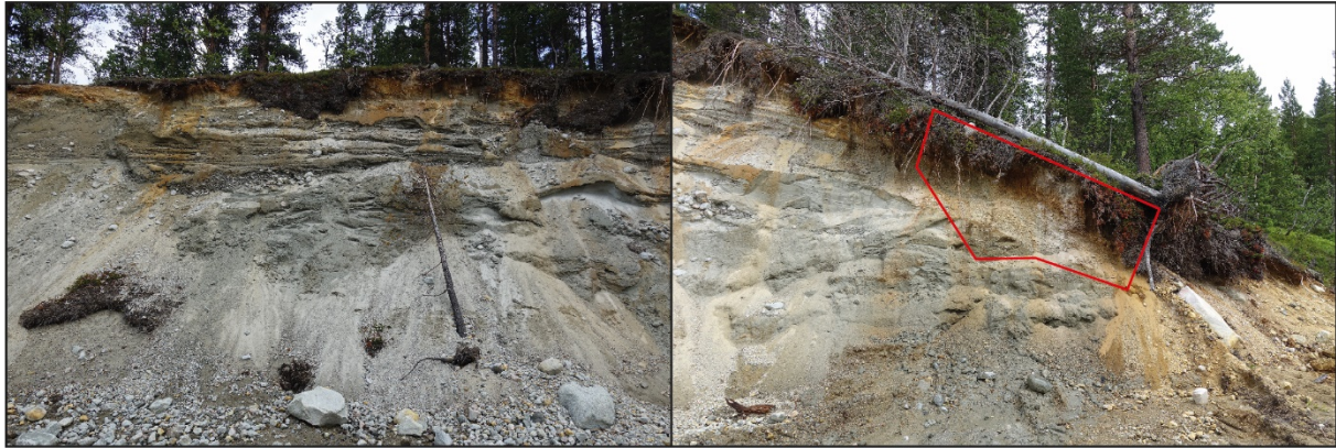
Figur 6: Bilder av massetak 2. Stoffen er ca. 8 m høy og materialet er utrast i nedre delen. I øvre delen finnes mange lag med ensgradert finkornet sand (bilde til høyre). Massene har her blitt tatt ut fra ca. 1984 og dette er uttaksområde som er brukt i dag til vedlikehold av sæterveien.
