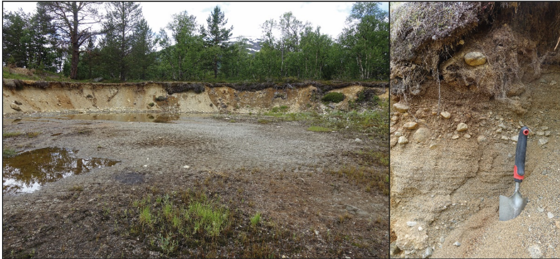
Figur 5: Bilder av massetak 1. Stoffen er ca. 2 m høy (venstre bilde) og består av sandig grusmaterial (høyre bilde). Materialet er grovere enn registrert i NGUs grus- og pukkdatabase (blå kurve i Figur 4).
