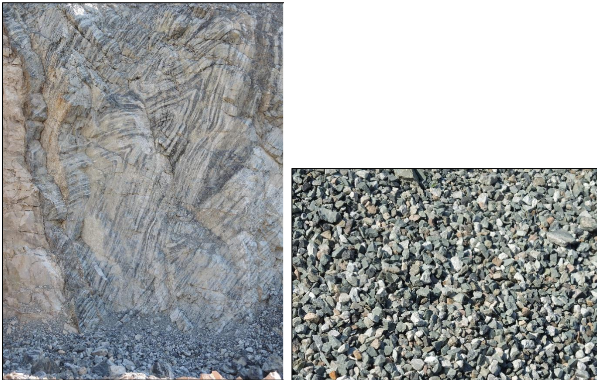
Figur 2 Bilder fra Lierskogen pukkverk. Bildet til venstre viser veksling mellom lys og mørk hornfels, dette skiller det ikke på i produksjonen. Bildet til høyre viser knust hornfels.
